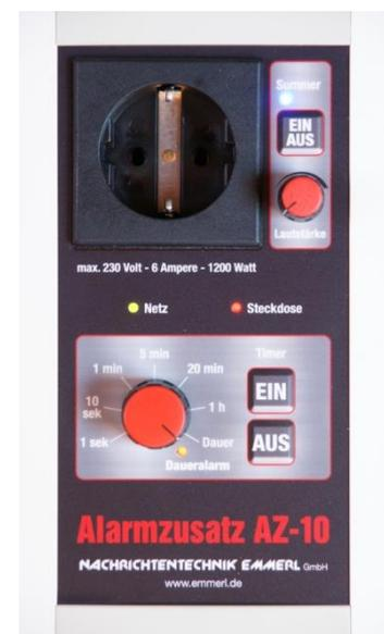
Der Eingang „Extern-EIN“ hat dieselbe Funktion wie die Taste „Timer EIN“. Um die Zeitsteuerung von außen zu aktivieren, verbinden Sie einfach die Pins 6 und 7 der SUB-D Buchse mit einem extern angeschlossenen Taster.
