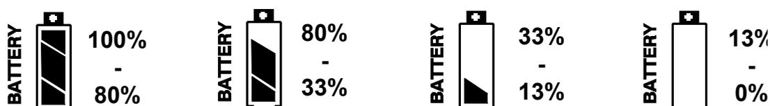
Im eingeschalteten Zustand ist das Batteriesymbol im Display immer sichtbar und zeigt Ihnen die verfügbare Energiemenge an. Die Betriebsdauer ist ca. 75 - 120 Stunden je nach programmierter Betriebsart und Versorgungsquelle. Ist die Energiequelle ganz verbraucht, blinkt das leere Batteriesymbol dauernd. Bei eingeschalteter Akustik ertönt gleichzeitig ein regelmäßiger Piepton. Es steht noch eine Betriebszeit von 3 - 5 Stunden zur Verfügung.
